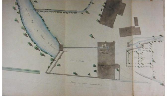
**Figure138** Gestion de l'eau du bief par un déversoir en amont du moulin
