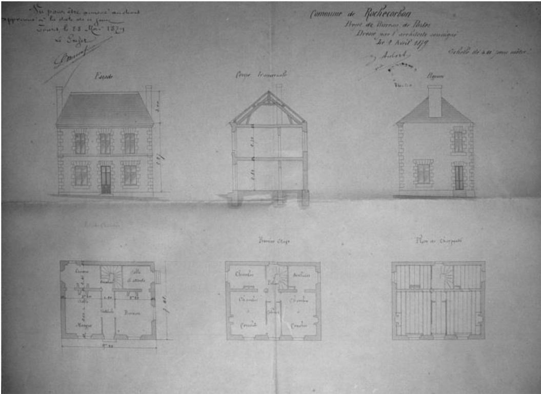
Figure 204. Plan du bâtiment de la Poste et télégraphe réf.37
