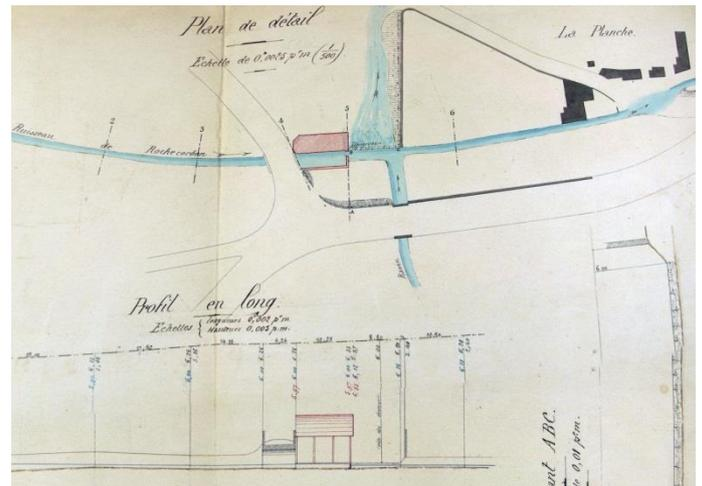
**Figure 198** Aménagement du lavoir de La Planche ; plan de 1875 montrant en rouge le bassin, la toiture abritant le lavoir, le déversoir. En face des maisons de la Planche il n'y a pas de pont mais un élargissement du bief pour permettre aux voitures de passer à gué
