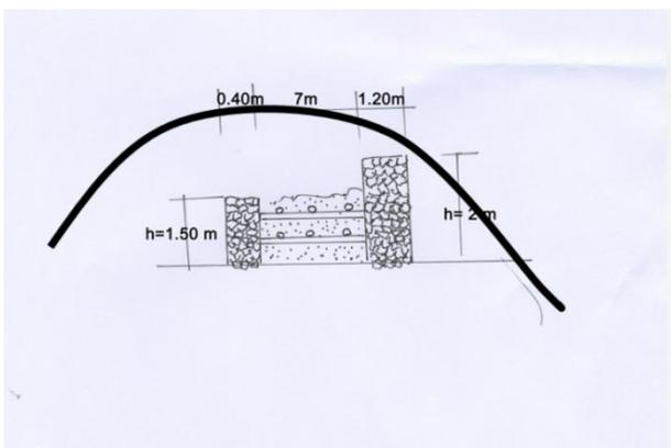
Figure 10 le Murus Gallicus (mur gaulois) avec ses deux murs de pierres sèches, enterré sous le talus
