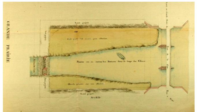
**Figure 48** Pont de Vouvray: à cet endroit la Cisse offre un refuge aux bateaux, particulièrement en cas de "glaces" L'ensablement partiel du lit est représenté (partie plus foncée). Ces écluses existent en amont du pont (la Loire est à droite de ce plan ; « grande prairie » indique le coté de Vernou) réf.37
