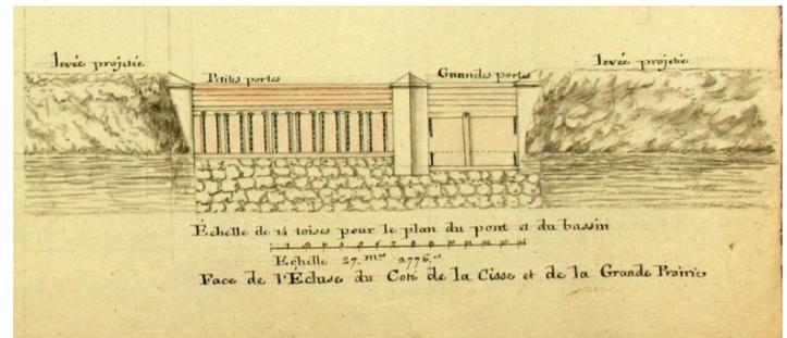
Figure 52 Projet de 1860 environ pour la réalisation d'une écluse à Vouvray<sup>réf.37</sup>
