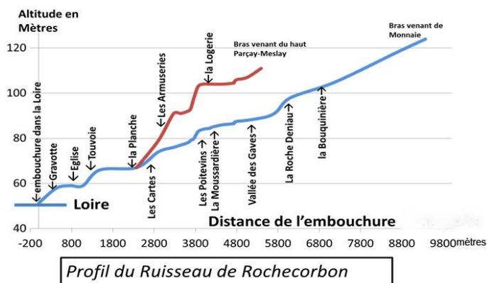
**Figure 78:** profil du ruisseau suivant ses deux bras principaux
