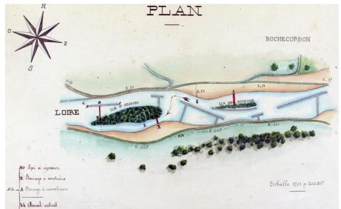
**Figure 47** En 1866 Des sapines<sup>13</sup> transportant des équipements transatlantiques fournis par la société Schneider du Creusot et destinées aux chantiers navals de Nantes furent précipitées par le courant au niveau de l'île St Georges et manquèrent de couler ; il fallut ajouter des barrages pour éviter que ce type d'incident se reproduise. (Le plan indique les travaux à effectuer autour de l'île de Saint Georges)
