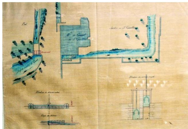
Figure 142 Le moulin de Gravotte en 1868; le bief est régulé par un canal de fuite, la roue est alimentée par un conduit sous la rue.
